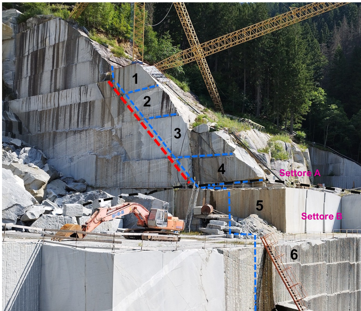
Fig. n. 1 – Si rappresenta sul fronte Est attuale (settore superiore del giacimento a monte del piano di taglio indicato con linea tratto-punto di colore nero) la sequenza e l'impostazione dei tagli delle bancate del settore Est superiore e del successivo approfondimento nel sottostante settore B, operando dall'alto verso il basso su superfici piane. Nella parte superiore il fronte Nord coincide con la superficie della prima frattura (K1) indicata sulla parete Est attuale con linea rossa tratteggiata.
